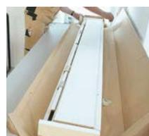
**04** Von Profis konstruiert für Zeitgewinn bei der Montage. Fixierung mit Excentern, Montage mit Lamellos und Stahl-Spannklammern.
