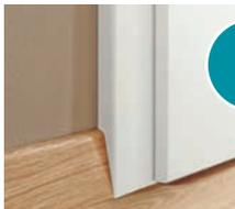
Zargenumbug 21 mm für einen perfekten Übergang zur Fußleiste. Dadurch mehr Material an Bekleidung und Futterbrett. Bekleidungsbreite 63, 75 oder 95 mm.
