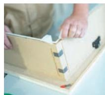
**05** Schnelle Umrüstung für die Aufnahme einer schweren Tür bis SSK 3 und Prüfklima c mit Hilfe des WE-Set. Es entsteht ein geprüftes WE-Element.
