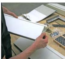
Tägliche Qualitätsprüfung anhand einer Zargenmontage und durch Messung der Werte.
